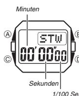
Mit der Stoppuhr können Sie die abgelaufene Zeit, Zwischenzeiten und zwei Endzeiten messen.
