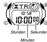
Der Countdown-Timer kann innerhalb des Bereichs von 1 Minute bis zu 24 Stunden eingestellt werden. Ein Alarm ertönt, wenn der Countdown Null erreicht.
